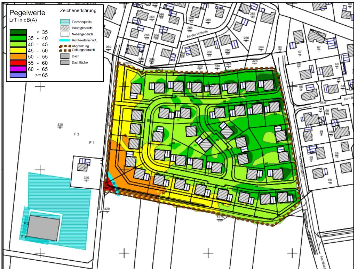
Bild 2: Varianten 1a - Isophonenkarte Tag (Ausschnitt aus Karte 1.1), Berechnungshöhe 4 m, genordet, ohne Maßstab
