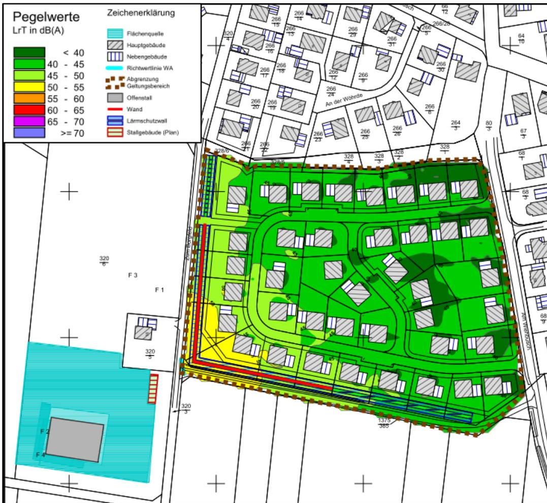
Bild 9: Variante 3 - Isophonenkarte Tag (Ausschnitt aus Karte 3.3, Berechnungshöhe 5,5 m, genordet, ohne Maßstab)
