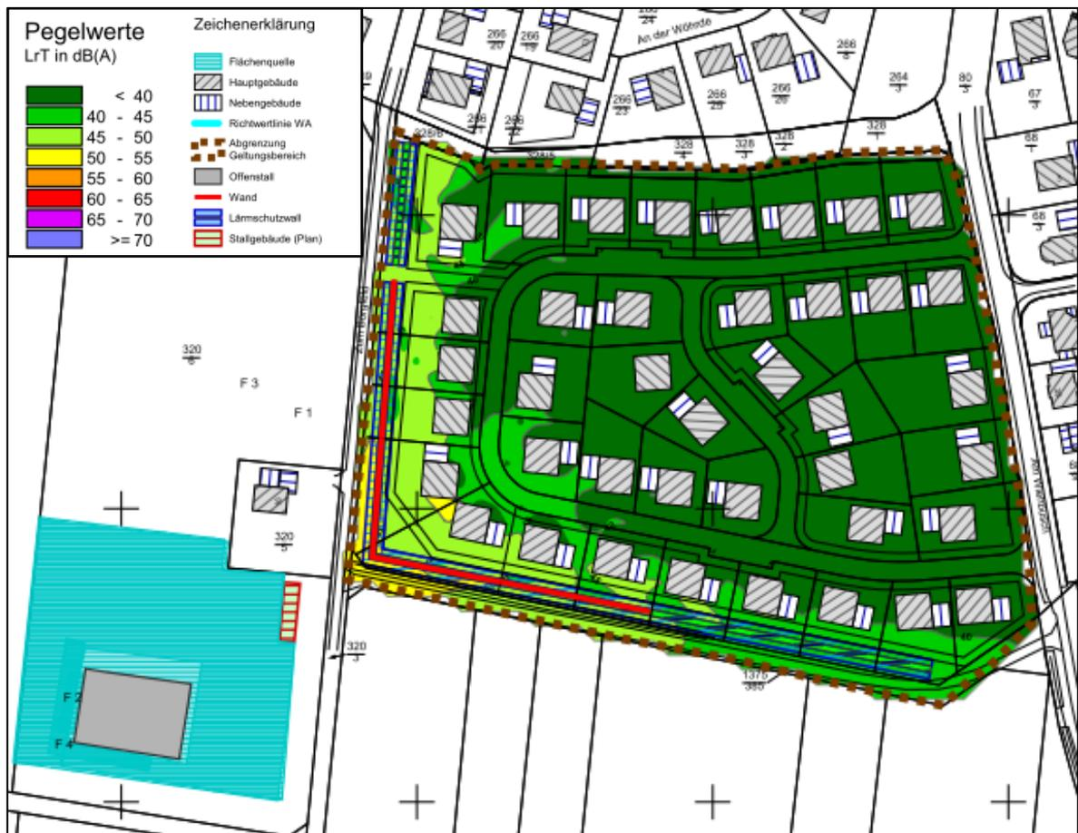
Bild 8: Variante 3 - Isophonenkarte Tag (Ausschnitt aus Karte 3.1, Berechnungshöhe 2 m), genordet, ohne Maßstab
