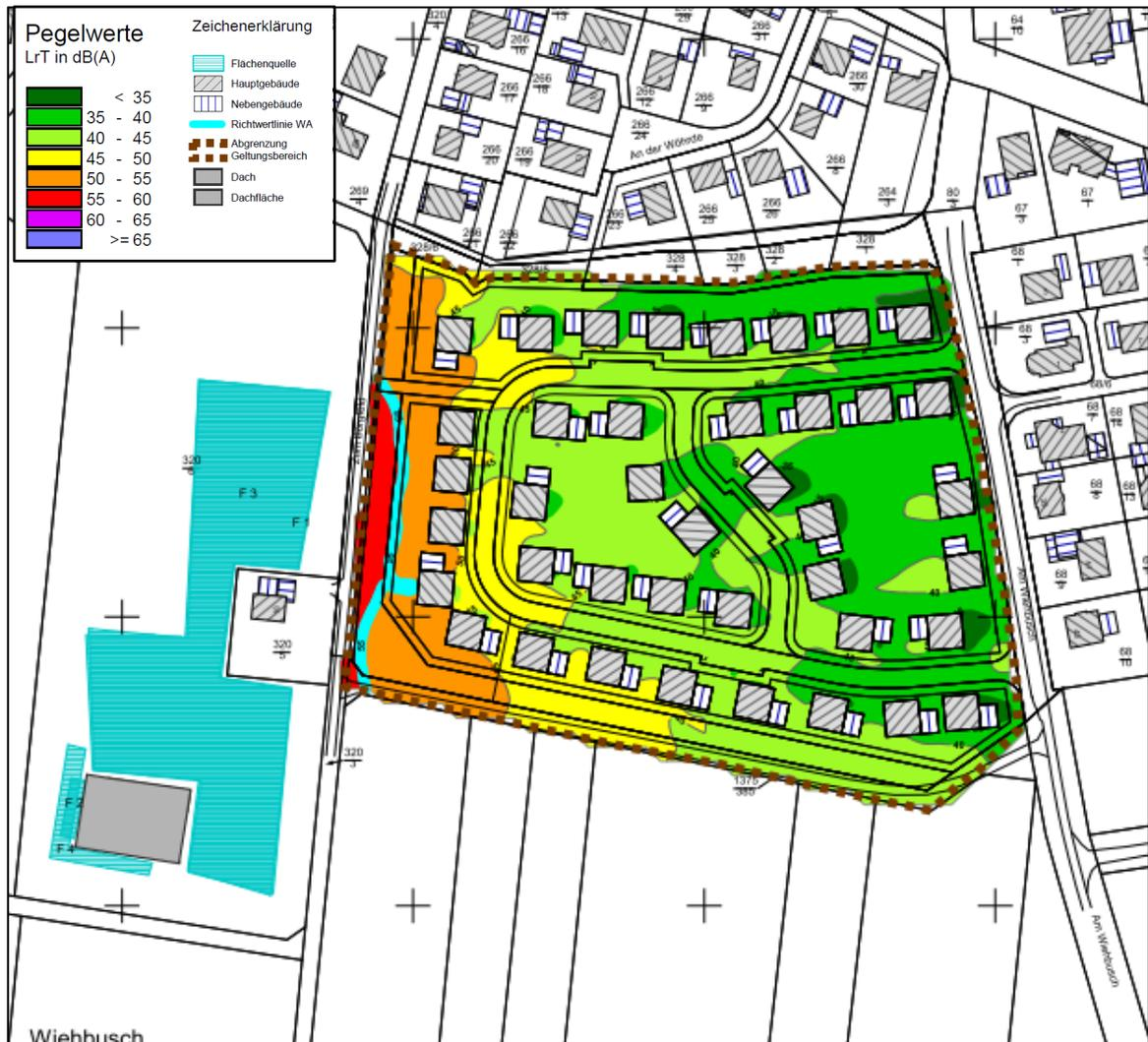
Bild 6: Variante 2 - Isophonenkarte Tag (Ausschnitt aus Karte 2.2, Berechnungshöhe 4 m, genordet, ohne Maßstab)
