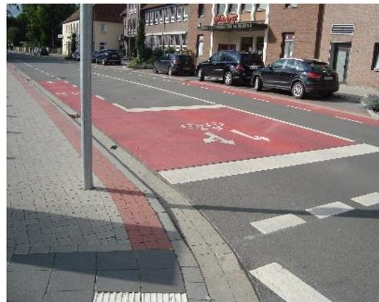
Abb. 25: Aufgeweiteter Radaufstellstreifen
