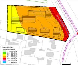
Abbildung 2: Maßgebliche Außenlärmpegel nach DIN 4109:2018-01 für Räume, die überwiegend zum Schlafen genutzt werden können
