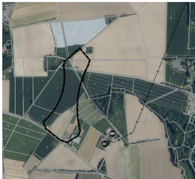
Abb. 14 Verlauf von unterirdischen Leitungstrassen
